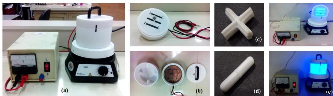
Figura 12. (a) Conjunto reatores-lâmpada LED, acompanhado com fonte de alimentação (esquerda) e sistema de agitação magnético (direita) (b) Partes do reator e lâmpadas (c, d) Tipos de barras de agitação: forma de estrela, barra lisa com anel central (e) conjunto em funcionamento.
