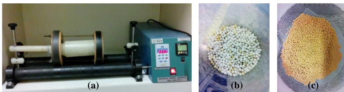
Figura 14. Moinho de bolas (a) e esferas (zirconia) usadas: tamanho 0,005 m (b) e tamanho 0,001 m (c)
