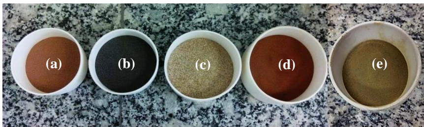
Figura 15. Materiais de suporte preparados: (a) argila natural, (b) argila expandida, (c) vermiculita, (d) argila natural modificada com amido 70:30 (m/m) e (e) Nontronita.
