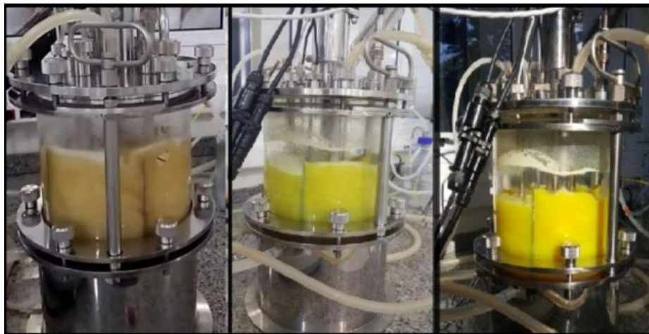
Figura 22. Fotos do biorreator operado em 1000 rpm, 25°C, 2 L/min de vazão de ar e meio de cultura composto de LB (25g/L) com adição de lactose 40 (g/L) nos momentos 0, 36 e 48 horas após o início do cultivo.
