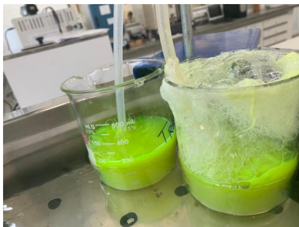
Figura 10. Experimento com oxigênio puro na vazão de 1 L/min em amostras diluída em tampão Tris-HCl 50 mM, pH 8,0 e outra amostra diluída em água, durante 8 horas.
