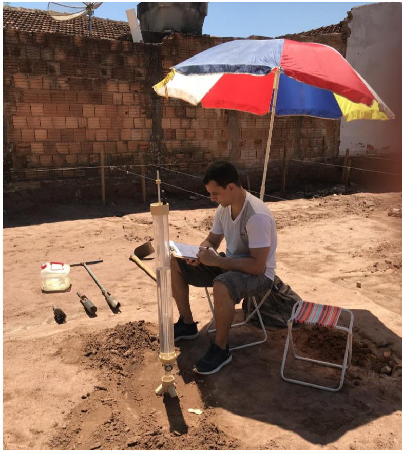
Figura 23 : Ensaio utilizando o permeâmetro de Guelph no Cemitério da Saudade.
