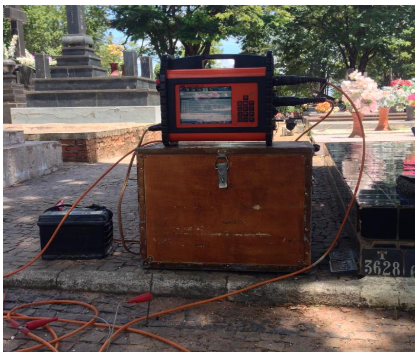
Figura 18: Equipamento utilizado para execução da técnica do imageamento elétrico.
