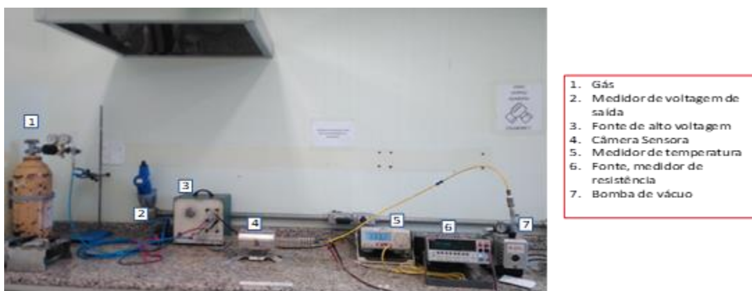
Figura 22. Equipamento usado para realização de medidas sensoras e suas respectivas partes.
