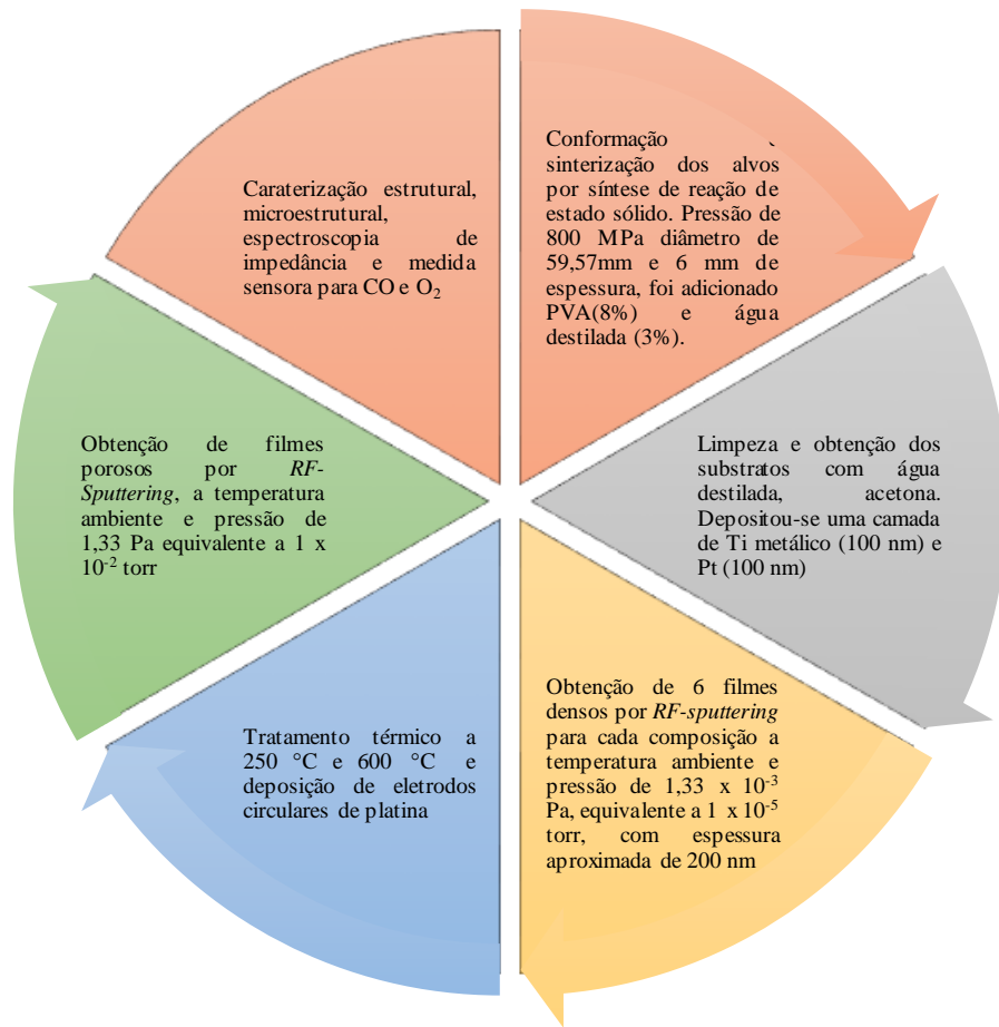
Figura 23. Fluxograma resumindo o procedimento na obtenção dos filmes densos e porosos de \text{CaCu}_{3-x}\text{Sr}_x\text{Ti}_4\text{O}_{12} com x = 0,00 e x = 0,15
