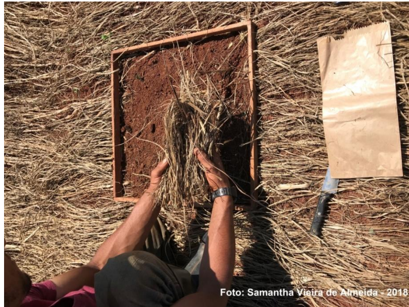
Figura 2 - Método Chaila (1986) de quantificação de palhada.
