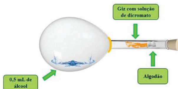
Figura E2.2. Imagem demonstrativa da construção alternativa de um bafômetro.
