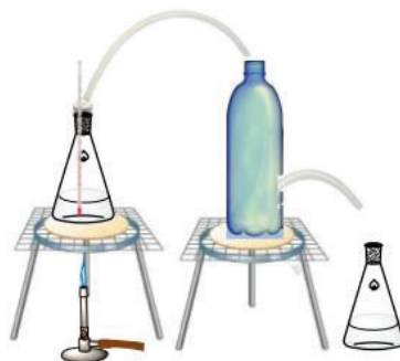
Figura E4.4. Sistema alternativo de destilação simples para a análise de álcool em vinho.
