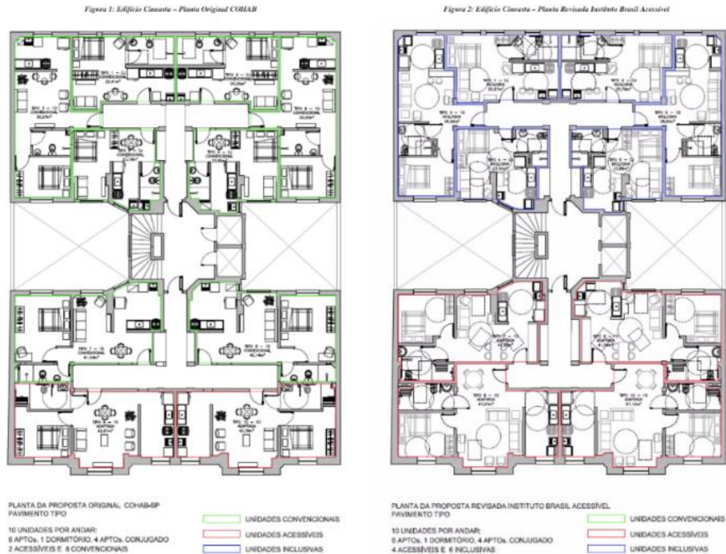
Figura 18 — Plantas do Edifício Cineasta (Palacete dos Artistas) (esq. Planta Original COHAB. dir. Planta Revisada pelo IBA)
