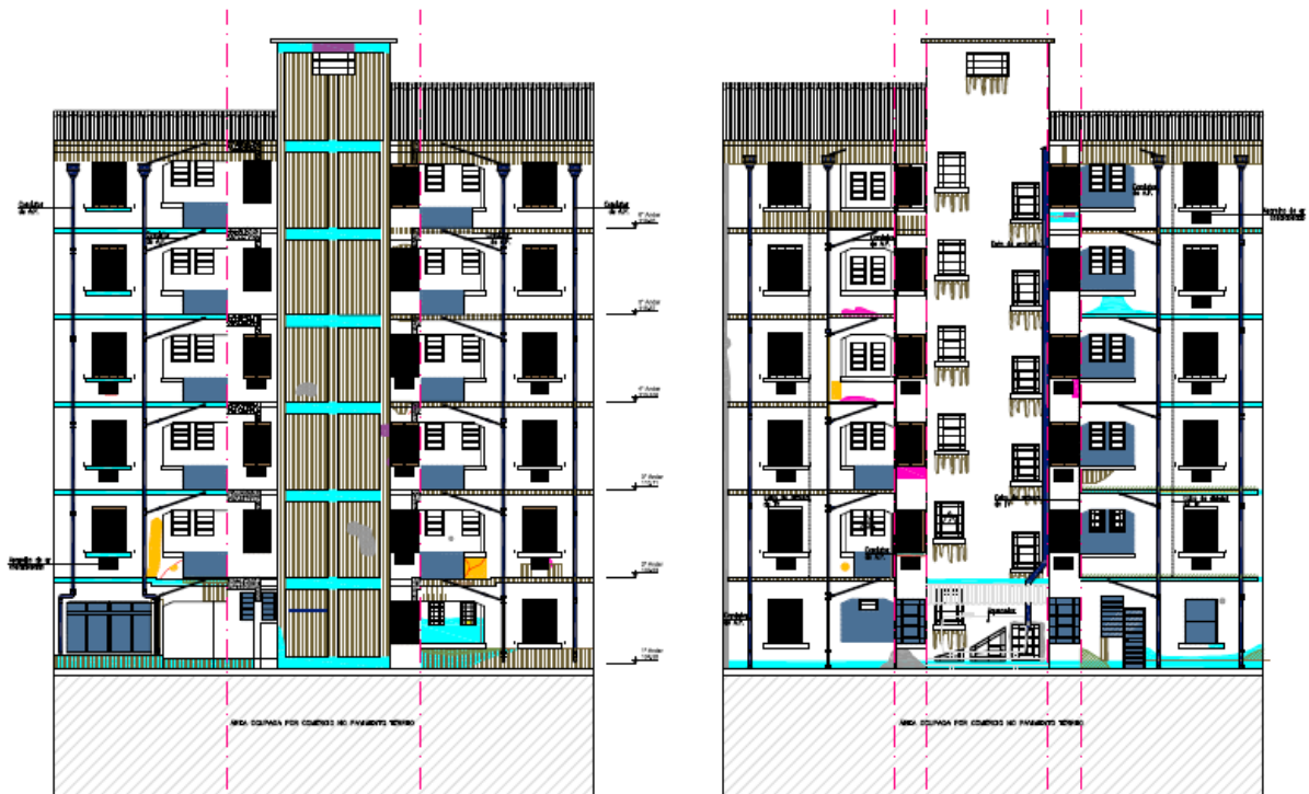
Figura 26 — Mapeamento de danos dos poços do Edifício Cineasta (Palacete dos Artistas), sem escala
