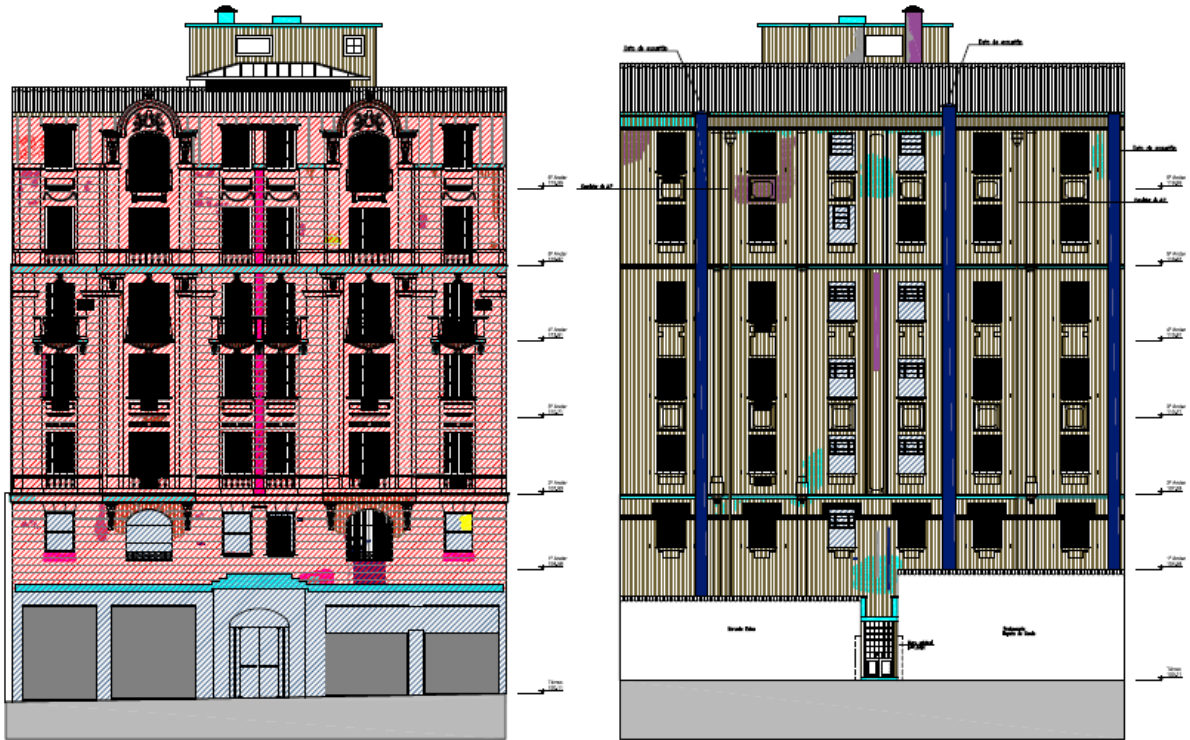
Figura 25 — Mapeamento de danos da fachada frontal e posterior do Edifício Cineasta (Palacete dos Artistas), sem escala
