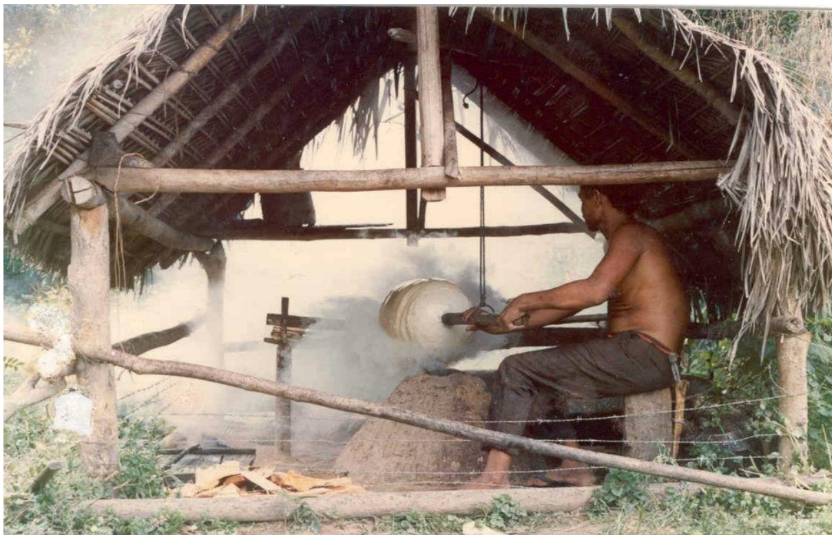
Imagem 4 – Defumador: a borracha, a fornalha, o “cavador” e o “pau de fumaça”.
