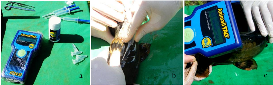
Figura 4. Identificação dos espécimes usando marcadores magnéticos ( tag ). a - leitor, tag e seringas; b - introdução da tag subcutânea com auxílio da seringa injetora; c- leitura da tag com auxílio do leitor.
