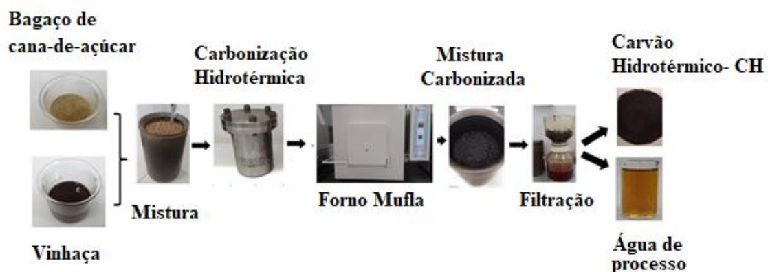
Figura 5. Etapas do processo de carbonização hidrotérmica para produção de Carvão Hidrotérmico (CH) obtido pela mistura de bagaço de cana e vinhaça
