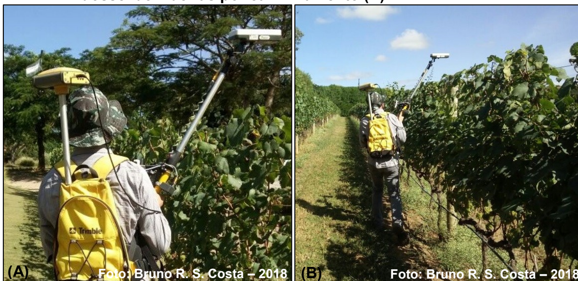
Figura 3 - Sensor Crop Circle ACS-430 (Holland Scientific Inc., Lincoln, NE, EUA) acoplado a um receptor GNSS HiPer® GGD (TOPCON, Pleasanton, CA, EUA) (A) e aquisição de dados de reflectância do dossel de videiras por caminhamento (B)
