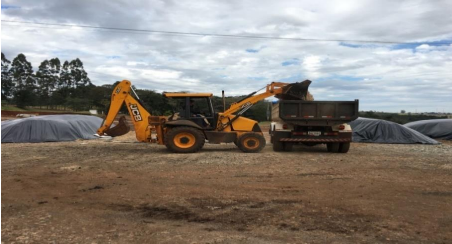
Figura 11 – Operação com retroescavadeira e caminhão basculante para montagem das leiras de compostagem
