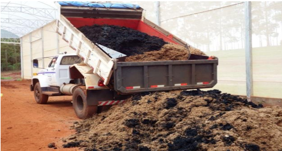
Figura 12 – Uso de caminhão basculante para formar as leiras de compostagem na estufa
