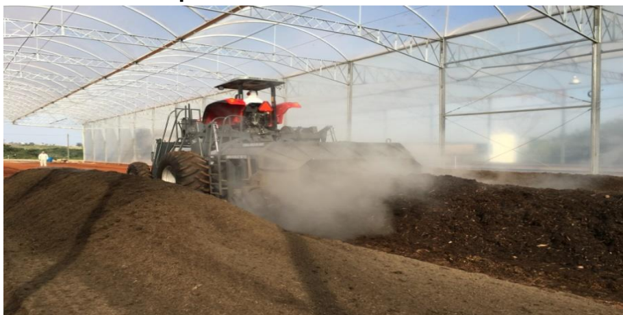
Figura 14 – Leiras de compostagem sendo revolvidas com a máquina compostadora
