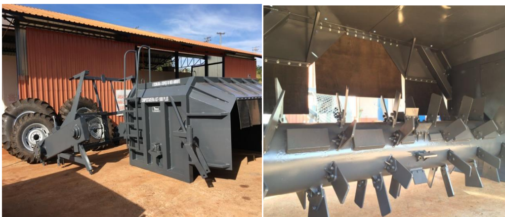
Figura 7 – Kit de elevação mecânica e compostador de resíduos
