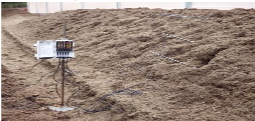
Figura 13 – Medição de temperatura com sensores acoplados a dataloguer
