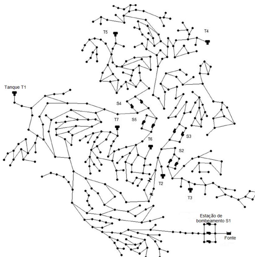
Figura 3.9 – Rede de distribuição de água C-TOWN. Fonte: Naoum-Sawaya et al. (2015).
