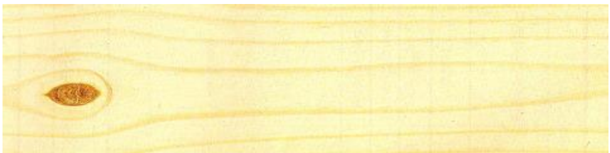
Figura 7 – Presença de nó firme em tábua de classe Super
