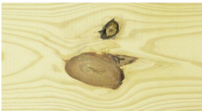
Figura 4 - Defeito caracterizado como nó cariado
