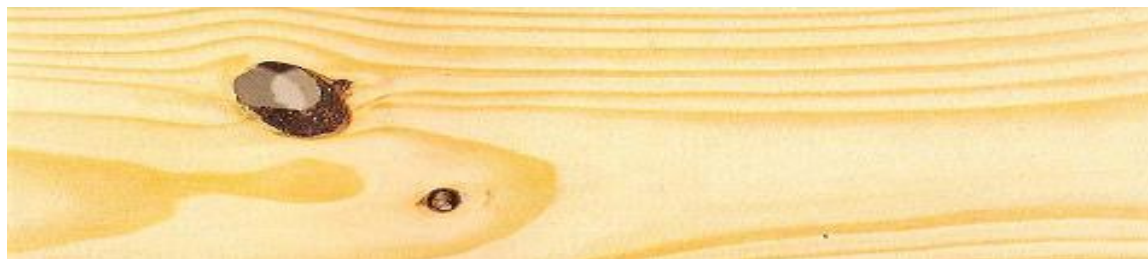
Figura 8 - Presença de nó vazado em tábuas de terceira classe
