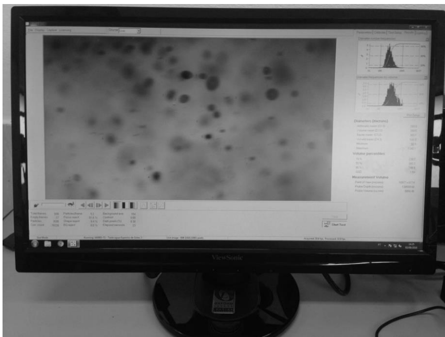
Figura 4. Software (Visisize Particle Sizing) analisando o tamanho das gotas pulverizadas em tempo real.
