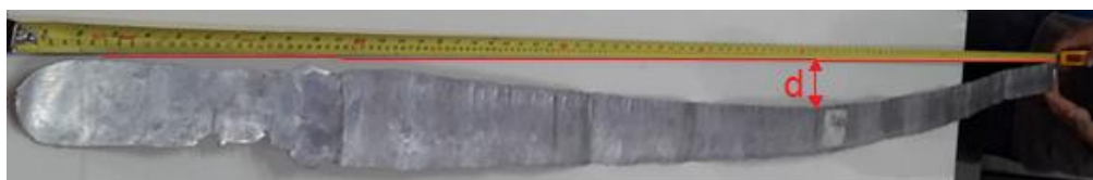
Figura 40- Esquema explicando o alinhamento de uma tira metálica fundida.
