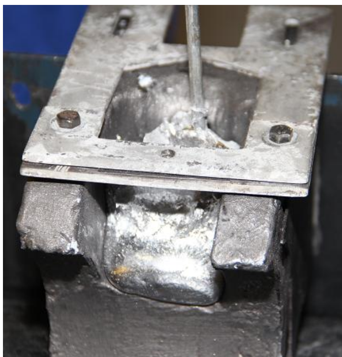
Figura 54 – Material solidificado na soleira do bocal na temperatura ambiente.
