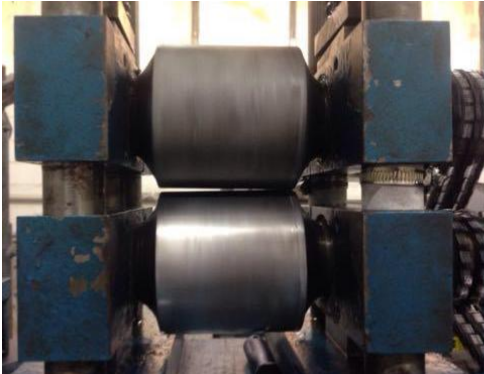
Figura 19 – Paralelismo dos cilindros do laminador em funcionamento.
