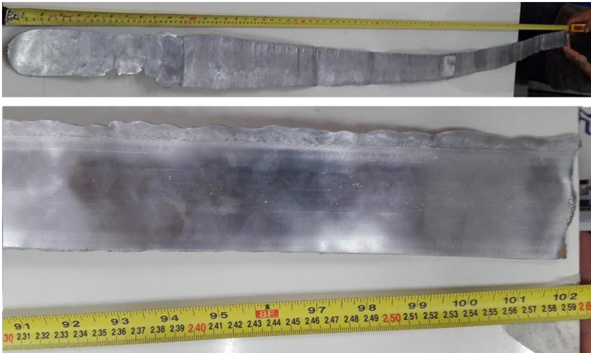
Figura 37 – Tira metálica da liga Al-Si A413 produzida pelo strip caster modificado com molas instaladas no cilindro superior. Comprimento de 2,6 m aproximadamente.
