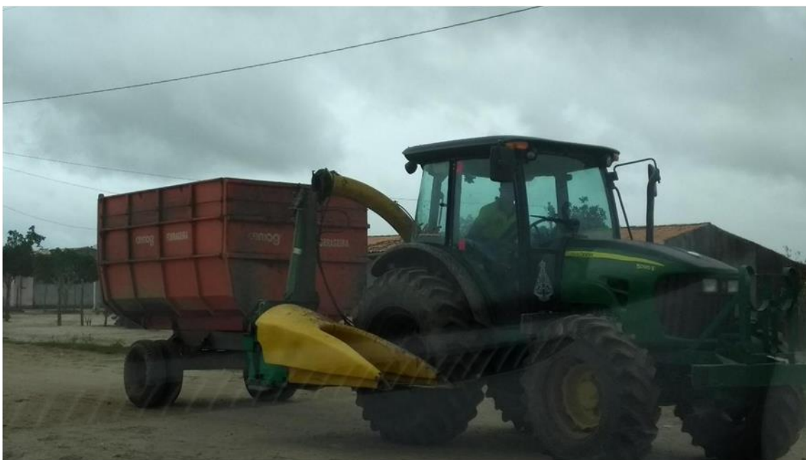
Imagem 1- Trator equipado para fazer a silagem.
