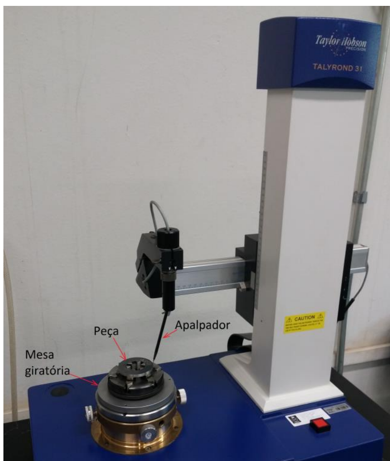
Figura 3.10. Medidor de circularidade marca Taylor Hobson, modelo Talyrond 31C.
