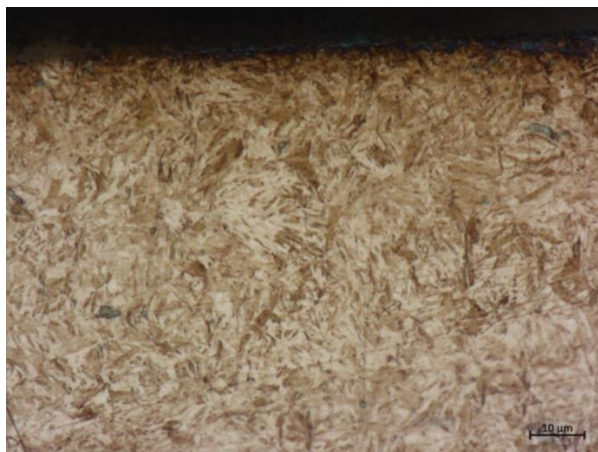
Figura 4.11. Microestrutura da peça retificada utilizando a técnica de MQL com Aqua 180 diluído em 83% de água sem limpeza (1000x).
