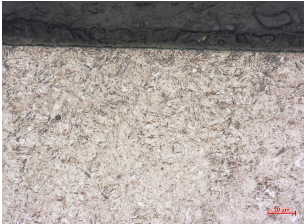
Figura 27: Microscopia de peça retificada com V_f=0,75 mm/min com o fluido V-active VCI (aumento 500X).
