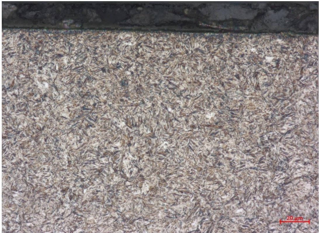
Figura 25: Microscopia de peça retificada com V_f=0,50 mm/min com VCI.
