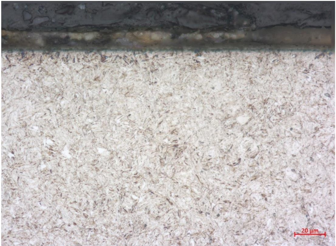
Figura 23: Microscopia de peça retificada com V_f=0,25 mm/min com o fluido V-active VCI (aumento 500X).
