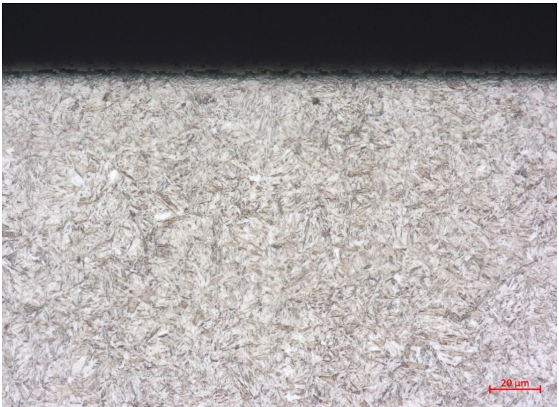
Figura 24: Microscopia de peça retificada com V_f=0,50 mm/min com o fluido base.
