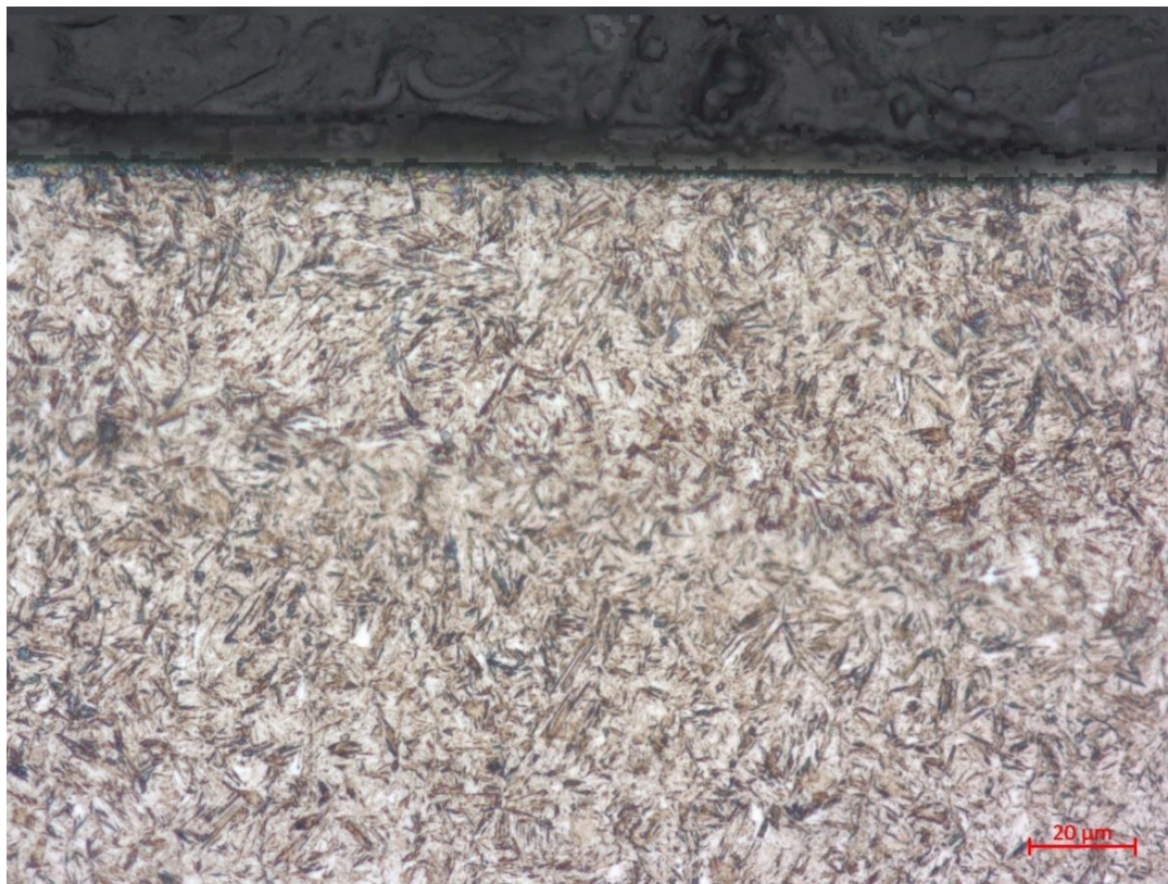
Figura 26: Microscopia de peça retificada com V_f=0,75 mm/min com o fluido base.
