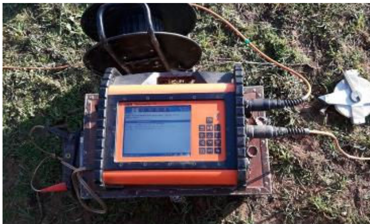
Figura 7.3 - Equipamento Terrameter LS (ABEM) utilizado na aquisição de dados geofísicos. Fonte: fotografia do autor.
