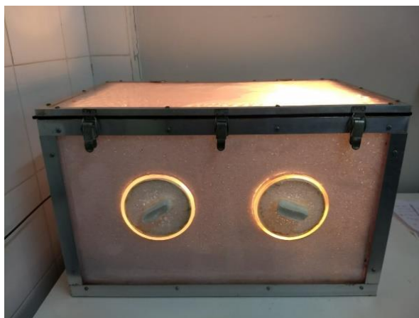
Figura 11: cabine com temperatura e umidade controladas
