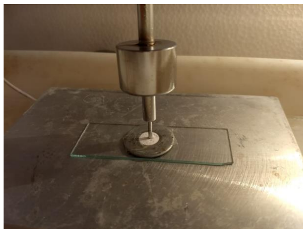
Figura 12: foto da medida do tempo de presa com a agulha de Gillmore dentro da cabine
