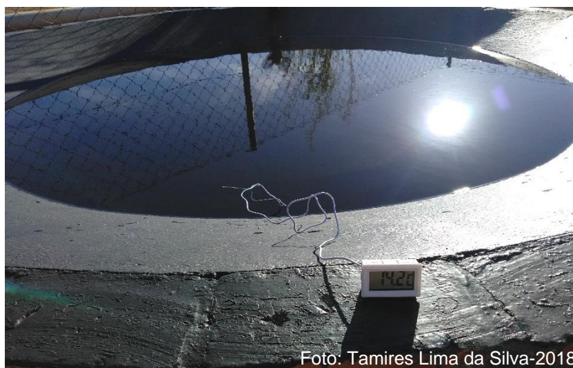
Figura 15- Medição da temperatura no SODIS
