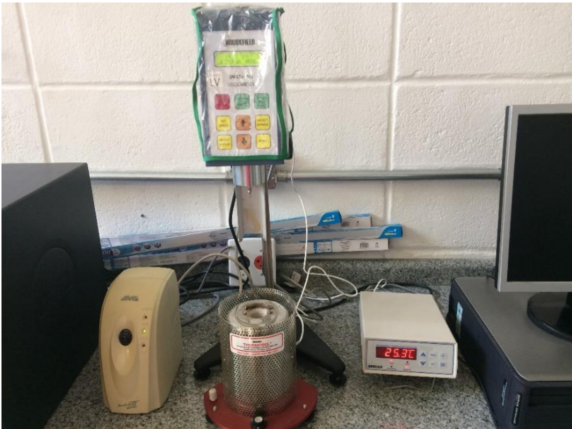
Figura 15 – Equipamento utilizado para verificar a viscosidade da resina polimérica - viscosímetro Brookfield/ DV-II+Pro.
