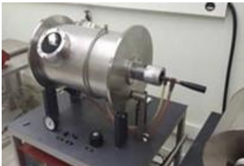
Figura 12 – Forno a arco voltaico utilizado para a obtenção da liga Ti10Mo8Nb.
