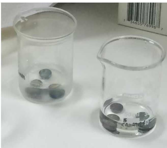
Figura 19 – Funcionalização das amostras da liga Ti10Mo8Nb anodizadas e incorporadas com óxido de ferro por meio do método spin coating (5 camadas).
