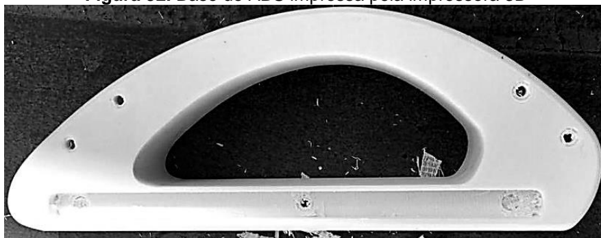
Figura 32. Base de ABS impressa pela impressora 3D
