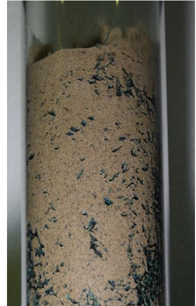
Figura 42 – Experimento em Duplicata para a seguinte configuração: Placa Perfurada; Areia 324 \mu\text{m} ; 10% de Casca de arroz (a) Perfil da queda de pressão do leito em função da velocidade do ar de fluidização (b) Perfil do leito durante a fluidização
