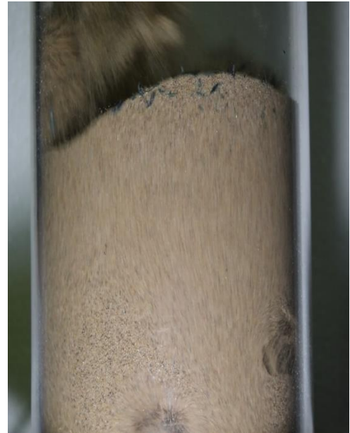
Figura 40 – Experimento em Duplicata para a seguinte configuração: Placa Perfurada; Areia 324 \mu\text{m} ; 1% de Casca de arroz (a) Perfil da queda de pressão do leito em função da velocidade do ar de fluidização (b) Perfil do leito durante a fluidização
