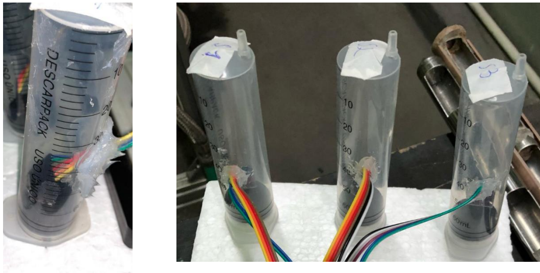
Figura 22 - Modelo Final dos sensores com as seringas para a medição de pressão (a) Seringa com o sensor BMP280 (b) Os três sensores com identificação para serem usados no leito
