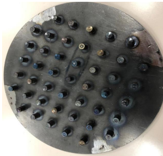
Figura 16 - Placa distribuidora com injetores do tipo tuyere usada no experimento.
