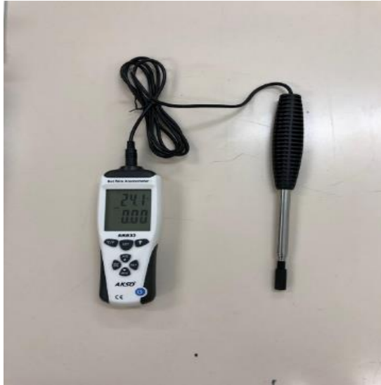
Figura 26 - Anemômetro de fio quente
