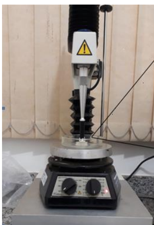
Figura 11. Imagem dos discos de mucina aderidos horizontalmente em prova cilíndrica em contato com formulação.
