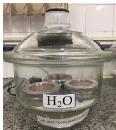
Figura 4 – Cápsulas de rosca com vedação de borracha (a) e amostras de filme fixas nas cápsulas e dispostas nos dessecadores (b)
