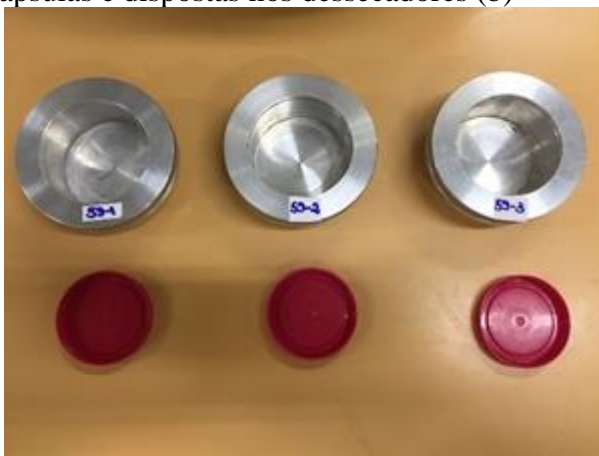
Figura 4 – Cápsulas de rosca com vedação de borracha (a) e amostras de filme fixas nas cápsulas e dispostas nos dessecadores (b)
