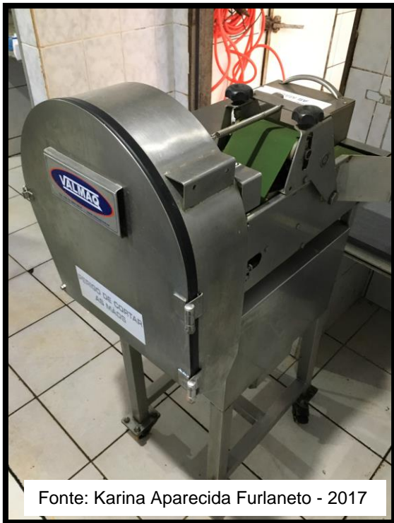
Figura 3 – Corte mecânico da couve-folha.
