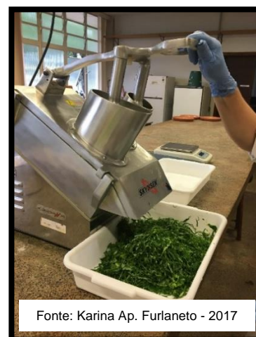
Figura 5 – Corte da couve-folha ‘Manteiga’ em processador semi-industrial.
