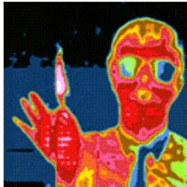
Figura 3 – Radiação eletromagnética sendo emitida pelo corpo humano na região do infravermelho.
