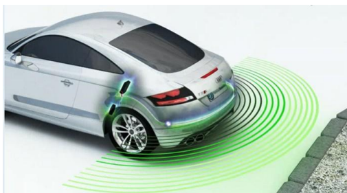
Sensores de estacionamento em carros usam sensor do tipo acústico (Foto: Reprodução/Parking Dynamics)
