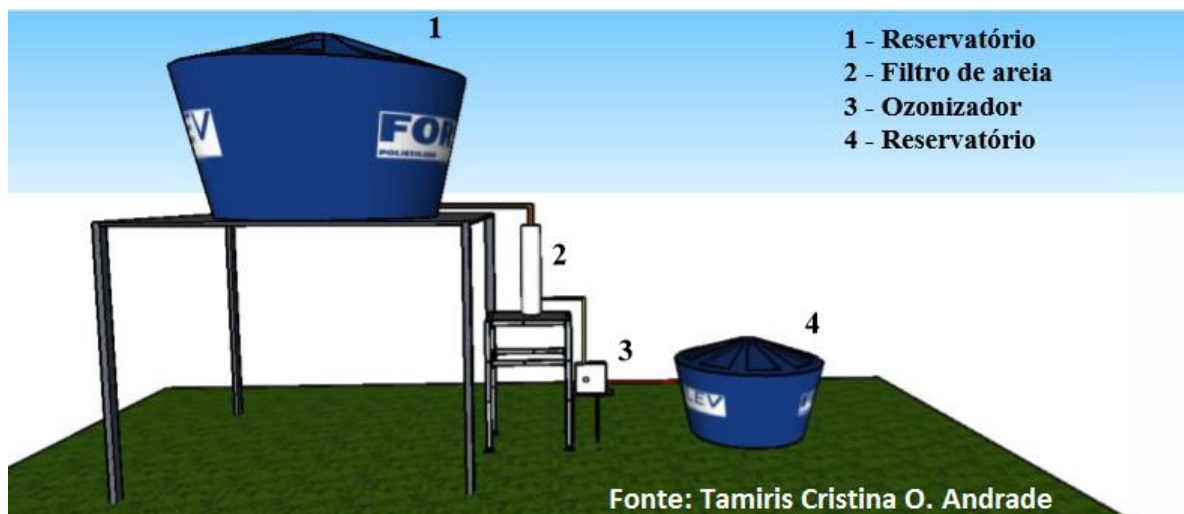
Figura 1 - Croqui do sistema de filtragem e ozonização proposto por Gomes (2016)
