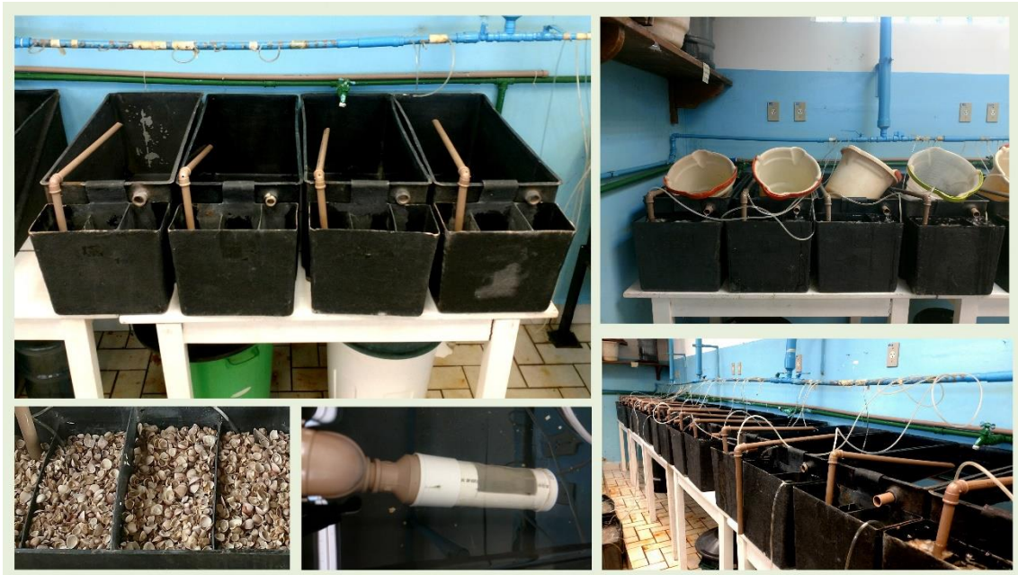
Figura 11. Montagem do experimento em ambiente “indoor” destacando as caixas de cultivo e sistema de recirculação de água.
