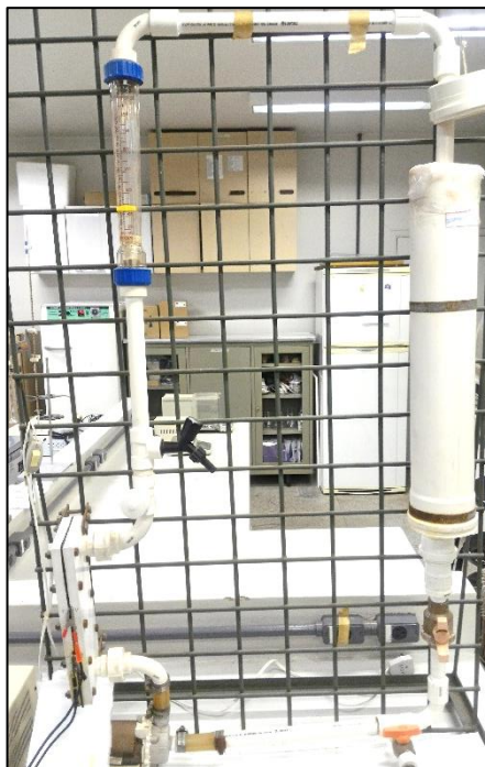
Figura 13 – Reator eletrolítico montado em estrutura metálica
