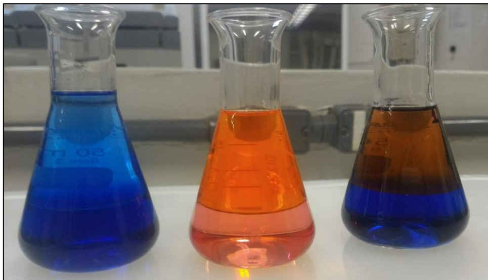
Figura 43 – Exemplo de extração dos efluentes simulados contendo os corantes, da esquerda para direita, Acid blue 40, Acid red 151 e a mistura dos corantes
