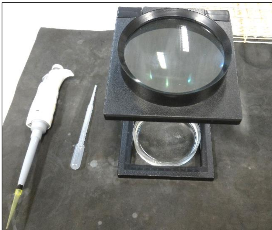
Figura 23 – Lupa e placa de Petri contendo naupli de A. salina para contagem
