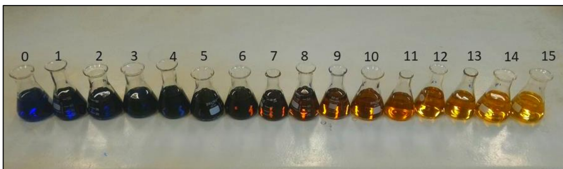
Figura 39 – Variação de cor para o tratamento eletrolítico otimizado do efluente simulado contendo o corante Acid blue 40. Amostras coletadas a cada 1 min de tratamento.
