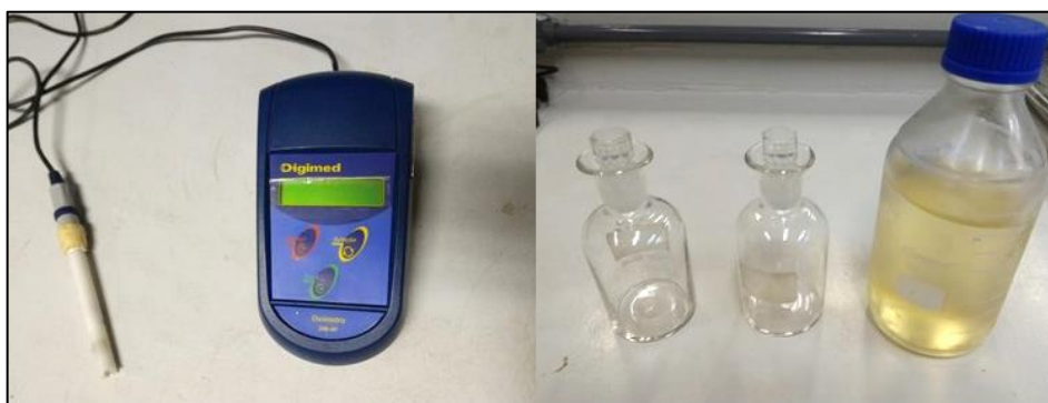
Figura 17 – Oxímetro da Digimed DMPH-2 (esquerda) e frascos de Winkler e água utilizada como semente
