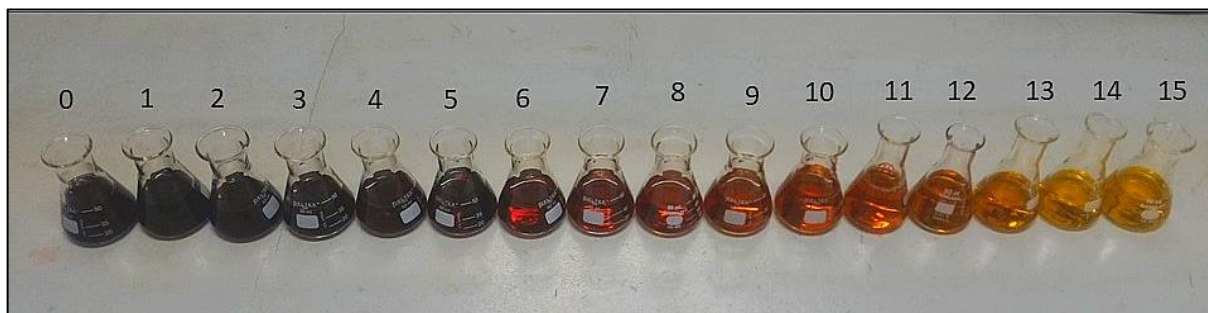
Figura 41 – Variação de cor para o tratamento eletrolítico do efluente simulado misto. Amostras coletadas a cada 1 min de tratamento
