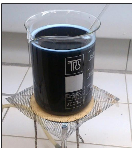
Figura 7 – Dissolução do corante Acid blue 40 por aquecimento
