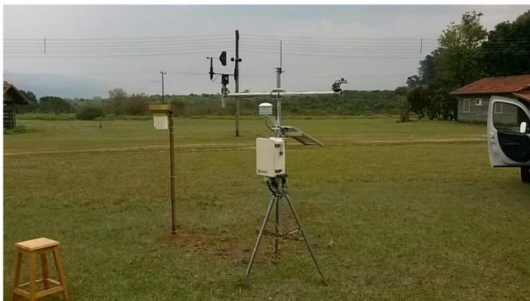
Figura 2.10 - Estação Climatológica Automática instalada próxima à sede da EEcSB
