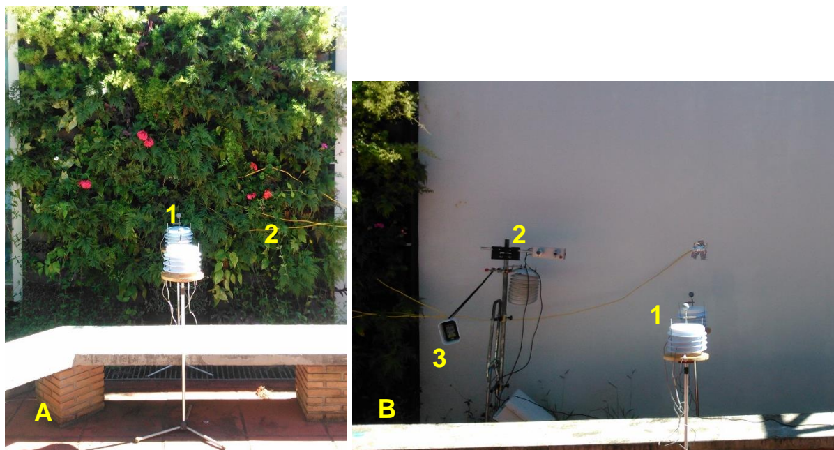
Legenda: A- Parcela com jardim vertical. 1- Tripés com datalogger HOBO para temperatura de bulbo seco, temperatura de bulbo úmido e temperatura de globo; 2- Sensores tipo K para temperatura superficial posicionados na superfície externa do jardim, interna da placa impermeabilizante e na parede externa protegida pelo jardim. B- Parcela sem jardim vertical. 1- Tripés com datalogger HOBO para temperatura de bulbo seco, temperatura de bulbo úmido e temperatura de globo; 2- estação meteorológica móvel com net-radiômetro paralelo à parede e 3- termômetro digital Instrutherm com sensores tipo K para temperatura superficial. Fotos tiradas às 13h. Fonte: O autor.
