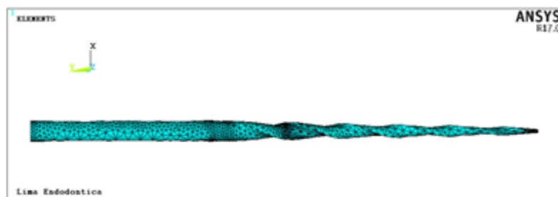
Figura 3. 23: Imagem instrumento com a malha no software Ansys
