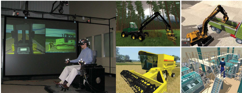
Figura 14 - Display montado na cabeça com sistema de videowall à esquerda, e simulações físicas avançadas em diversas aplicações à direita.
