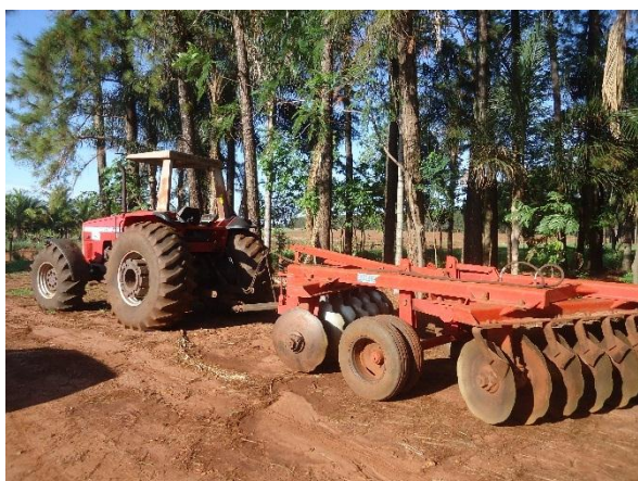
Figura 12. Implemento utilizado para realizar o manejo do solo com grade pesada (esquerda), e aspecto geral da área experimental após o manejo do solo (direita).
