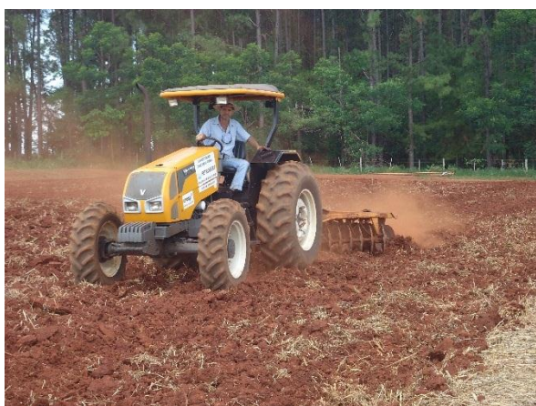
Figura 31. Primeira (esquerda) e segunda (direita) operação de nivelamento com grade leve.
