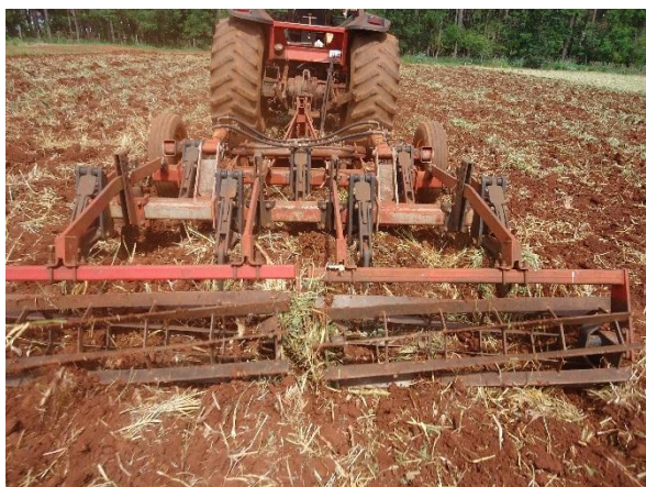
Figura 11. Implemento utilizado para realizar o manejo do solo com escarificador (esquerda), e aspecto geral da área experimental após o manejo do solo (direita).
