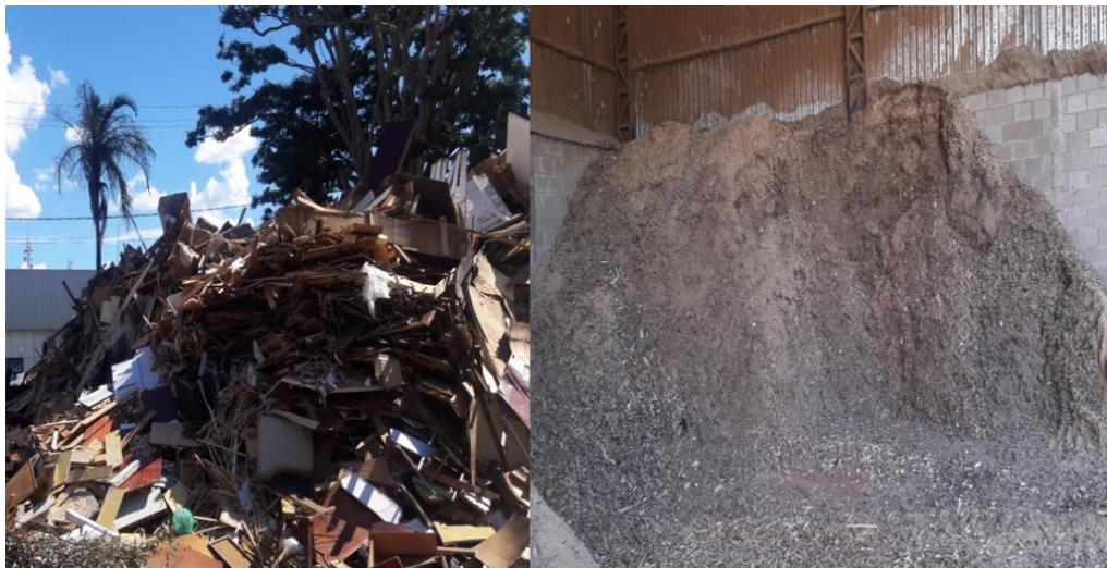
Figura 21 - Recebimento, trituração e armazenamento de outros resíduos de madeira
