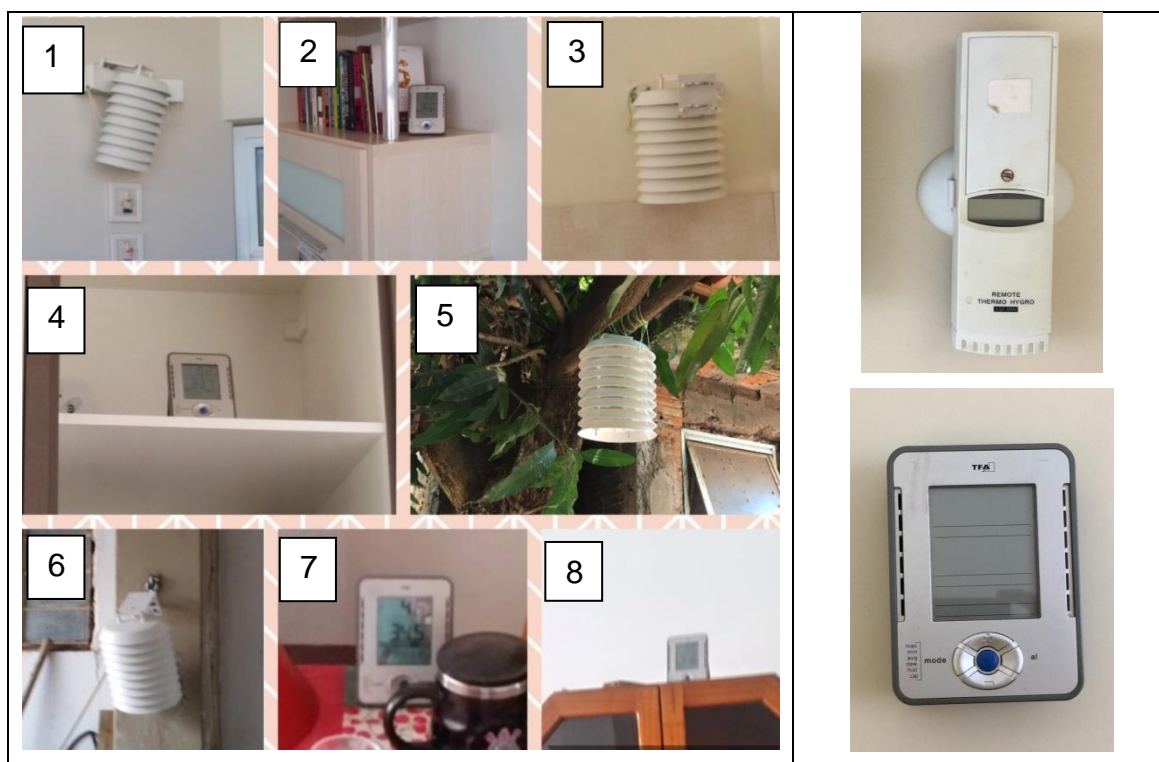
Figura 73 - Alguns dos locais onde os sensores foram instalados no ambiente interno e externo (sensor com proteção): 1 e 2, Residencial Dahma; 3 e 4, Vila Dubus; 5 e 8, Parque Castelo Branco; 6 e 7, COHAB; Equipamentos utilizados na pesquisa. Acima sensor externo e abaixo sensor interno.
