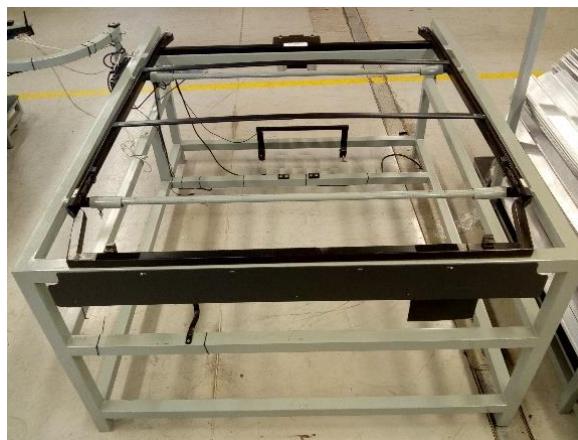
Figura 4.1 – Estrutura do dispositivo de inspeção.
