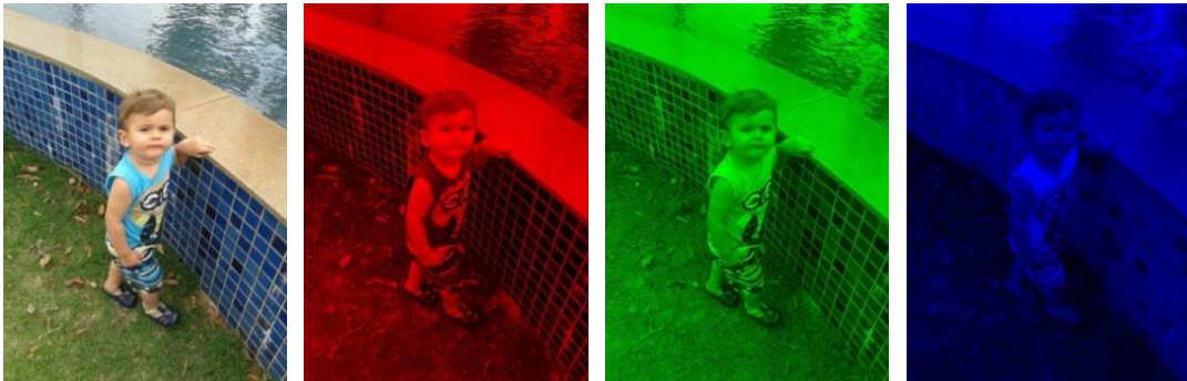
Figura 2.5 – Imagem de 24 bits e seus componentes RGB.
