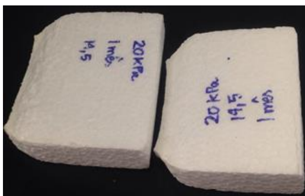
Figura 72 - Corpos de prova degradados após 30 dias após exposição ao vapor de gasolina
