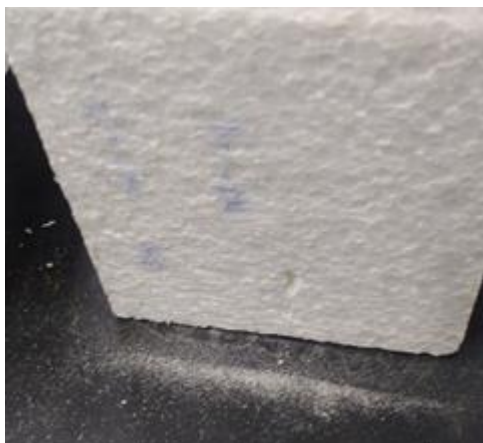
Figura 46 – Desprendimento de material de amostras expostas à intempérie
