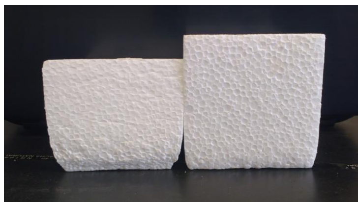
Figura 71 - Corpos de prova expostos ao vapor de gasolina, antes e após ensaio de compressão
