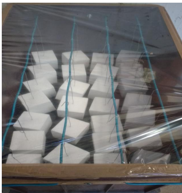
Figura 33 – Corpos de prova em exposição ao vapor de gasolina
