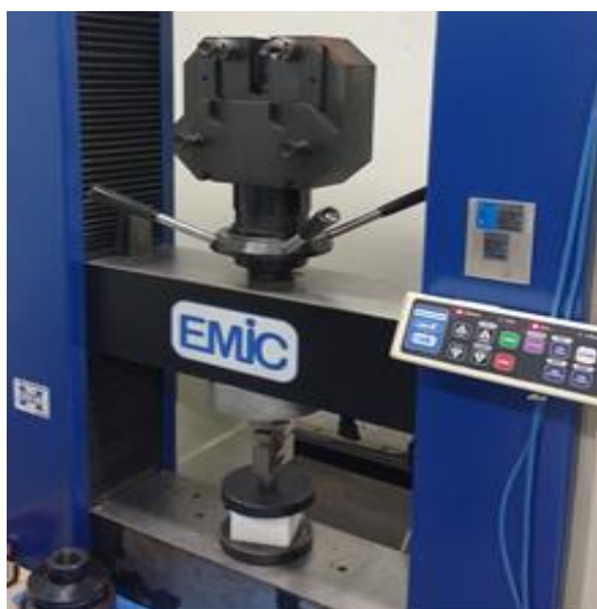
Figura 36 – Realização de ensaio de compressão axial em amostra cúbica
