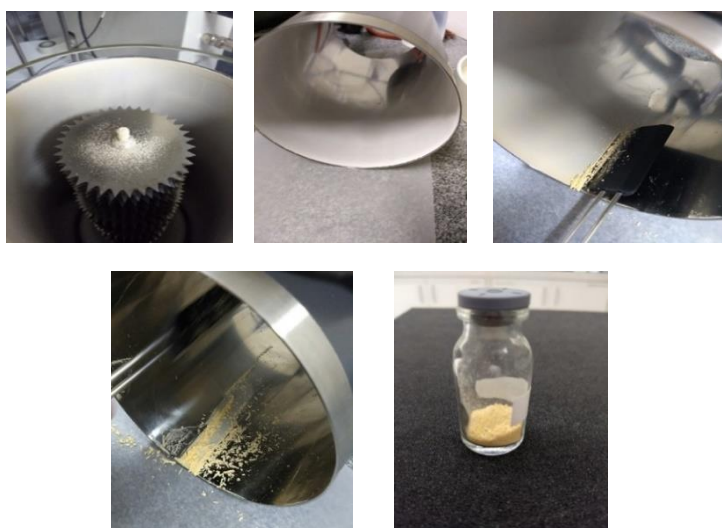
Figura 8 - Fotos do eletrodo e coleta da amostra após a atomização pelo Nano Spray Dryer .
