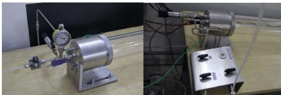
Figura 17 - Tubo para propagação da chama, com detalhe das tampas instaladas com instrumentação e controles.
