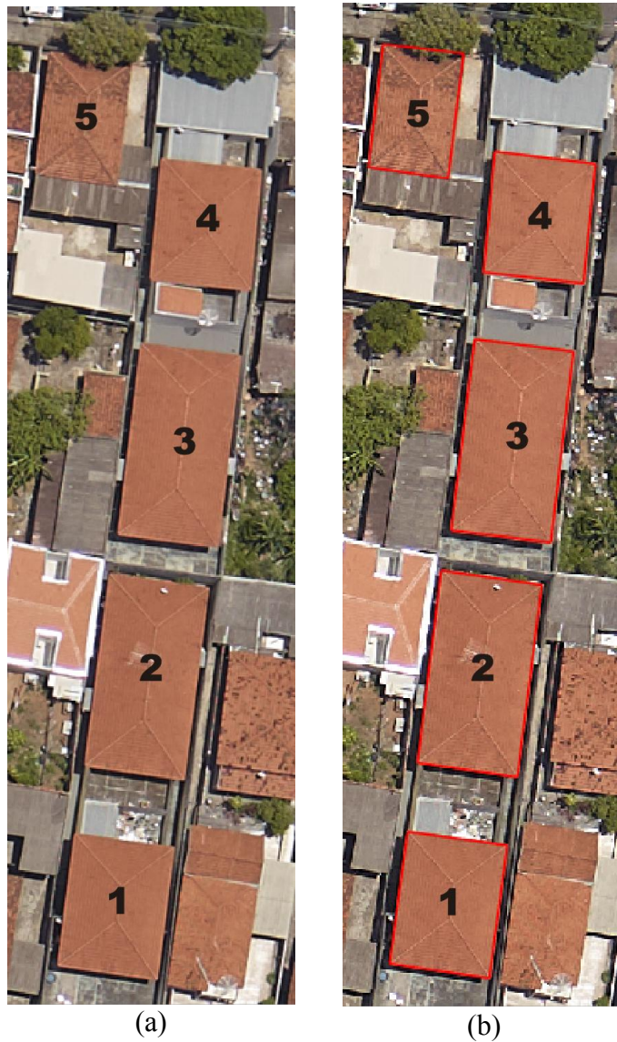
Figura 44 – Área utilizada no Experimento 2 contendo sombras adjacente aos telhados. (a) Imagem aérea das áreas utilizadas; (b) Contornos de referência (vermelho).
