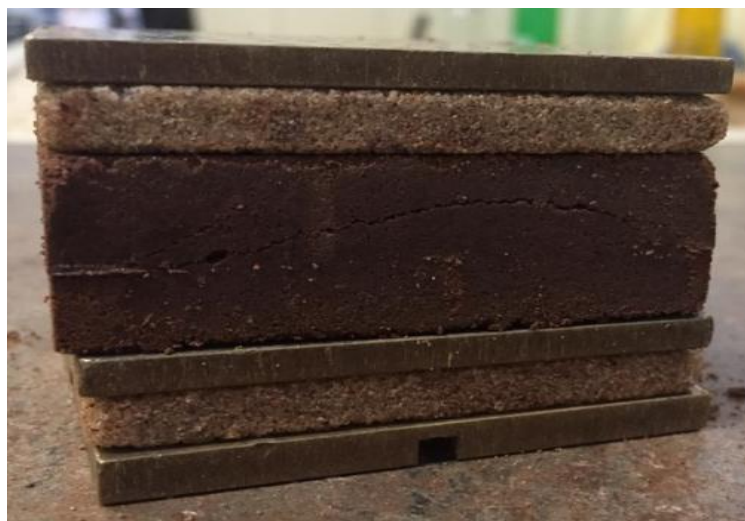
Figura 5.21 – Plano de ruptura obtido com o rompimento de corpo de prova com adição de 2% de cimento e tiras de maneira aleatória.
