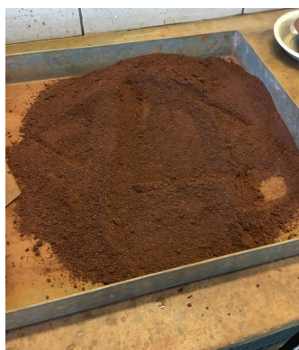
Figura 4.6 – Solo homogeneizado após adição de cimento e água em quantidades previamente calculadas no ensaio de compactação.
