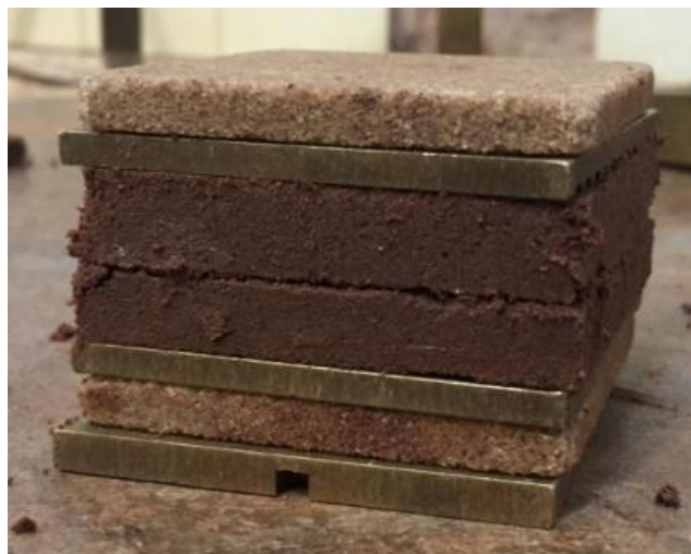
Figura 5.20 – Plano de ruptura obtido com o rompimento de corpo de prova com adição de 2% de cimento.
