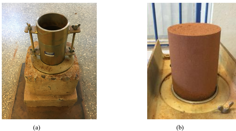
Figura 4.7 – Procedimentos executados em ensaio de compactação, evidenciando (a) molde cilíndrico acoplado à base utilizado para compactação do corpo de prova (b) corpo de prova após ser feita sua extração do molde.
