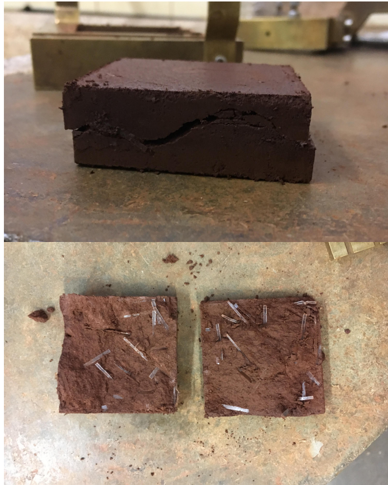
Figura 5.22 – Plano de ruptura obtido com o rompimento de corpo de prova com adição de 2% de cimento e tiras de maneira aleatória e posicionamento das tiras em relação a este plano.
