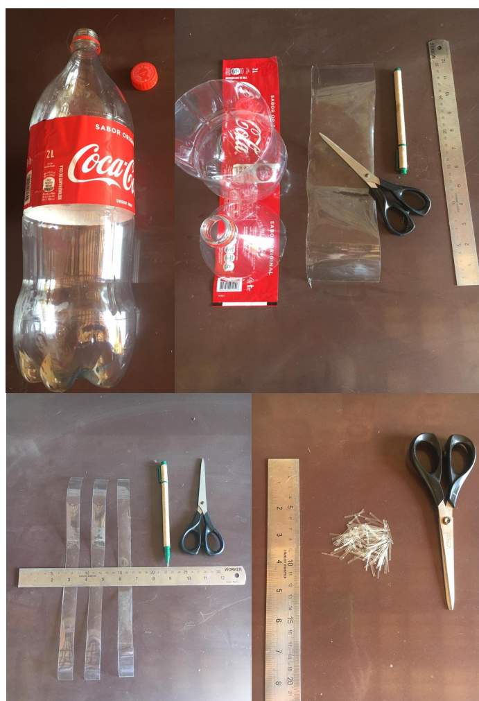
Figura 4.4 – Etapas da preparação das fibras PET de 20 mm, a partir da reutilização de garrafas de Coca-Cola.
