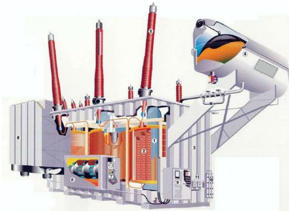
Figura 1.4 - Características construtivas de um transformador de potência.
