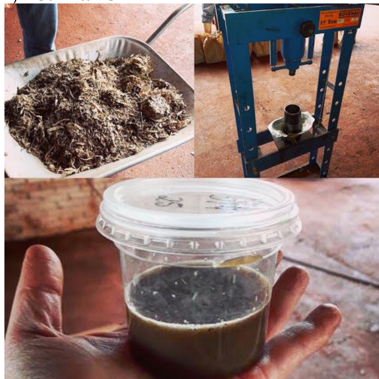
Figura 15. Coleta do suco da silagem com a utilização da prensa no dia da abertura dos silos experimentais no ano de 2017 na Fazenda de Ensino, Pesquisa e Extensão (FEPE) – Selvíria/MS.
