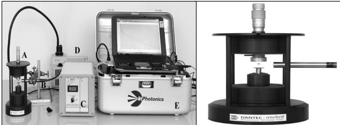
Figura 6. Levitador com espectrômetro Raman para monitoração sistemática ambiental. Fonte: Adaptado de A portable Raman acoustic levitation spectroscopic system for the identification and environmental monitoring of algal cells, Wood et al., 2005.
