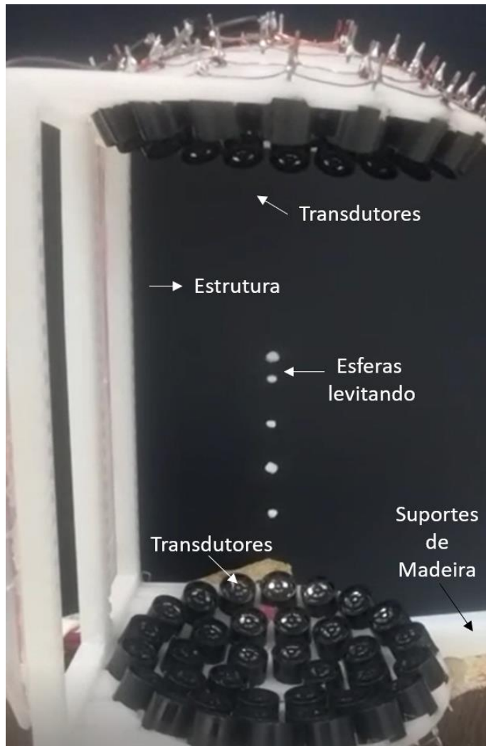
Figura 30. Levitador acústico com suportes de madeira improvisados, levitando cinco partículas de isopor.
