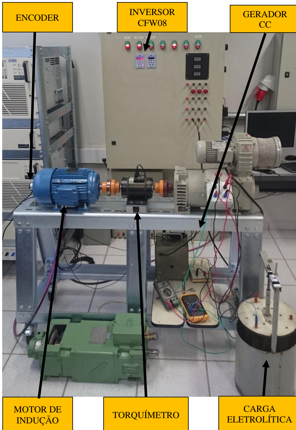
Figura 48 – Visão Geral da Bancada Experimental
