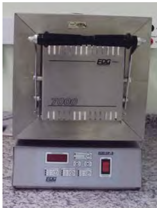
Figura 10 - Forno mufla utilizado para o processo de calcinação
