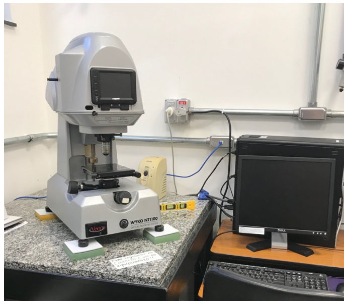
Figura 14 - Perfilômetro Óptico Veeco, modelo NT1100 do Instituto Nacional de Pesquisas Espaciais – INPE
